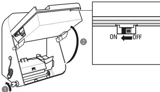
5. Druk op de serviceknop. De serviceknop bevindt zich aan de binnenkant van het toestel naast het blauwe wielje voor het instellen van het displaycontrast. Let op: de hoorn moet op het haakcontact geplaatst zijn.
