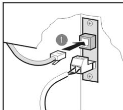
15. Steek de andere ministekker van het korte toestelaansluitsnoer in het aansluitpunt (2).
