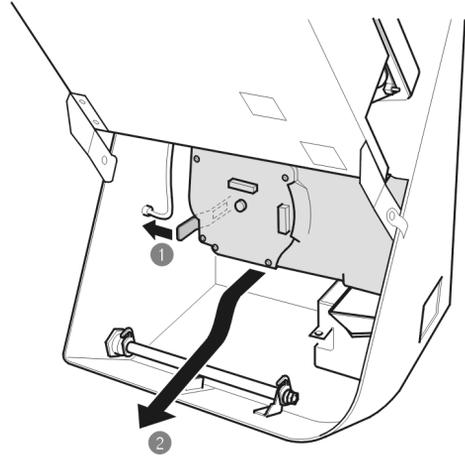
2. Knip het aansluitsnoer door en trek de ministekker uit het aansluitpunt. Haal het snoer uit de snoergeleiders.
