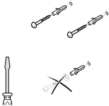
9. Draai in de beide bovenste gaten de schroeven zo ver vast dat er een afstand van ongeveer 4,5 mm tussen de schroefkop en de wand overblijft.
