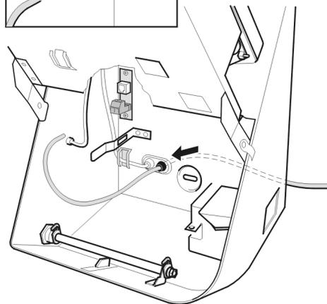
14. Steek de ene ministekker van het korte toestelaansluitsnoer in het bovenste contactpunt van het printje (1).
