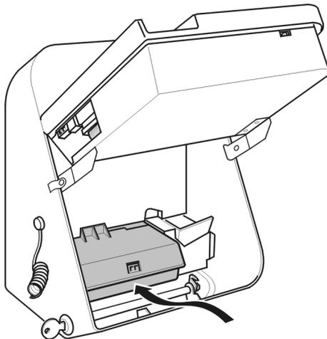
10. Til het bedieningsdeel een klein stukje op, druk de beide steunen tegelijkertijd naar binnen, sluit de telefoon en draai de Coinvox Euro op slot.
