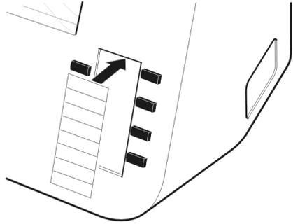
2. Breng de transparante afdekking aan. De nokken zijn asymmetrisch aangebracht zodat de afdekking maar op één manier kan worden geplaatst.
