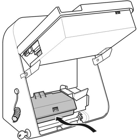
22. Til het bedieningsdeel een klein stukje op, druk de beide steunen tegelijkertijd naar binnen, sluit de telefoon en draai de Coinvox Euro op slot.
