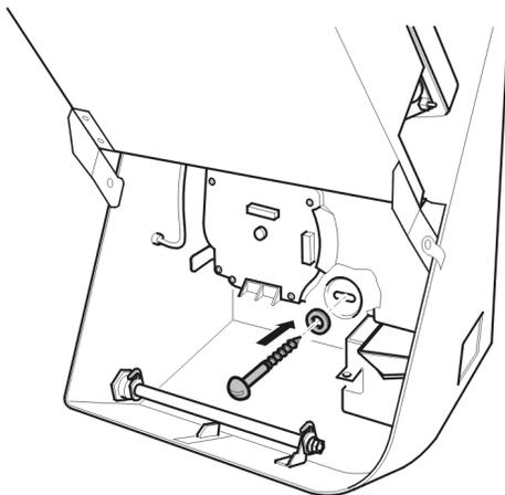
19. Richt de telefoon met behulp van een waterpas en draai de schroef vervolgens vast aan.
