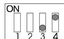
78 RPM Filter 'on'
